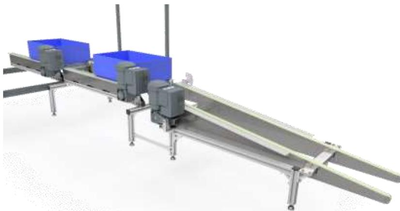
Die Aufgabenstellung der Firma SSI Schäfer an das Projektteam war es, eine Übergabestation für Behälter (600 x 400 x max. 280mm; max. 50 kg) aus einem Hochregallager auf ein Weasel (Bodentransporteinheit) zu entwickeln. Hierbei muss ein Höhenunterschied zwischen Lagerfach und Weasel auf kürzestem Weg, der über einen Zahnriemenförderer geradlinig aus dem Regal heraus führt, überwunden werden. Zusätzlich sollen die bis zu zwei
